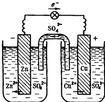
Р и с. 122. Схема гальванического элемента
