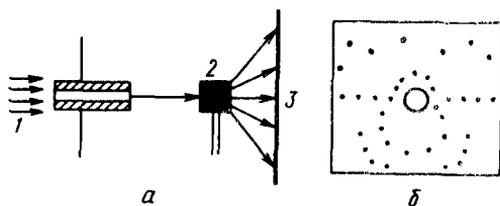
Р и с. 100. Схема рентгеновского исследования кристаллов (*а*) и рентгенограмма (*б*)
