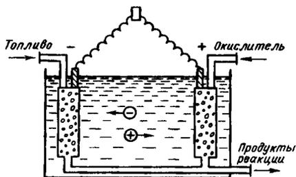
Р и с. 123. Схема топливного элемента
