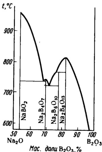
Рис. 189. Диаграмма плавкости системы  $\text{Na}_2\text{O}-\text{B}_2\text{O}_3$
