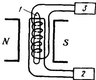
Р и с. 94. Схема радиоспектроскопа для исследования ЯМР:
