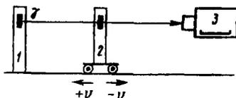
Р и с. 97. Схема установки при изучении поглощения  $\gamma$ -квантов
