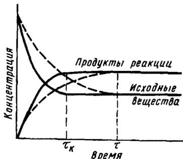
Рис. 120. Химическое равновесие в системе в присутствии катализатора и в отсутствие катализатора
